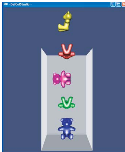
Abbildung 4.8: Anfangsposition der Simulation mit fünf Teddybären die zusammen 2860 Oberflächendreiecke enthalten.
